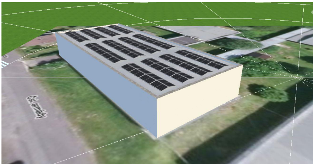
Umístění panelů s orientací východ - západ
