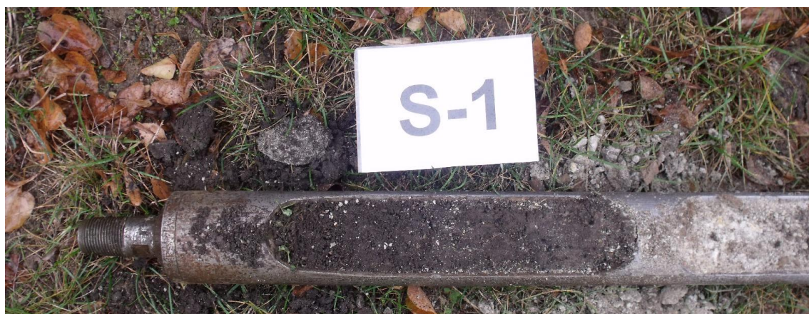
Obr. 5 Zastížené horniny sondou S-1 v hloubce 0,0 – 0,5 m
