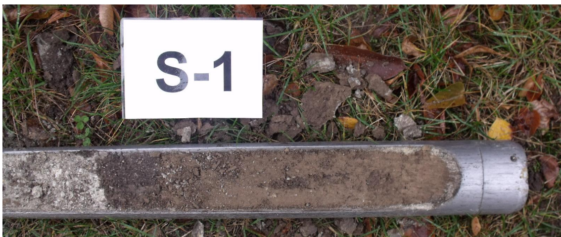
Obr. 6 Zastížené horniny sondou S-1 v hloubce 0,5 – 1,0 m
