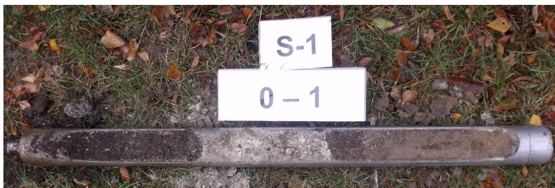
Obr. 4 Zastížené horniny sondou S-1 v hloubce 0,0 – 1,0 m
