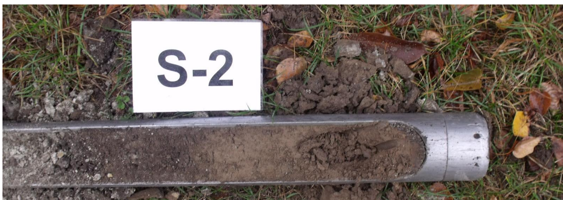
Obr. 13 Zastižené horniny sondou S-2 v hloubce 0,5 – 1,0 m
