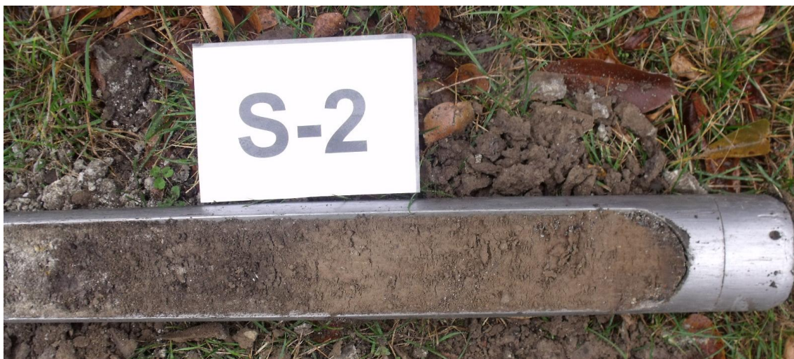
Obr. 10 Zastižené horniny sondou S-2 v hloubce 0,5 – 1,0 m
