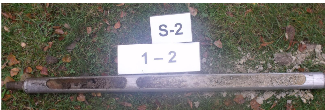
Obr. 14 Zastižené horniny sondou S-2 v hloubce 1,0 – 2,0 m
