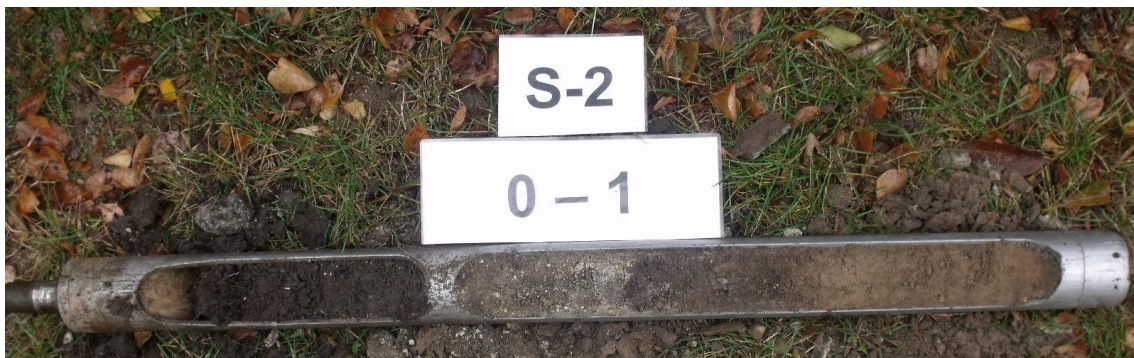
Obr. 8 Zastížené horniny sondou S-2 v hloubce 0,0 – 1,0 m
