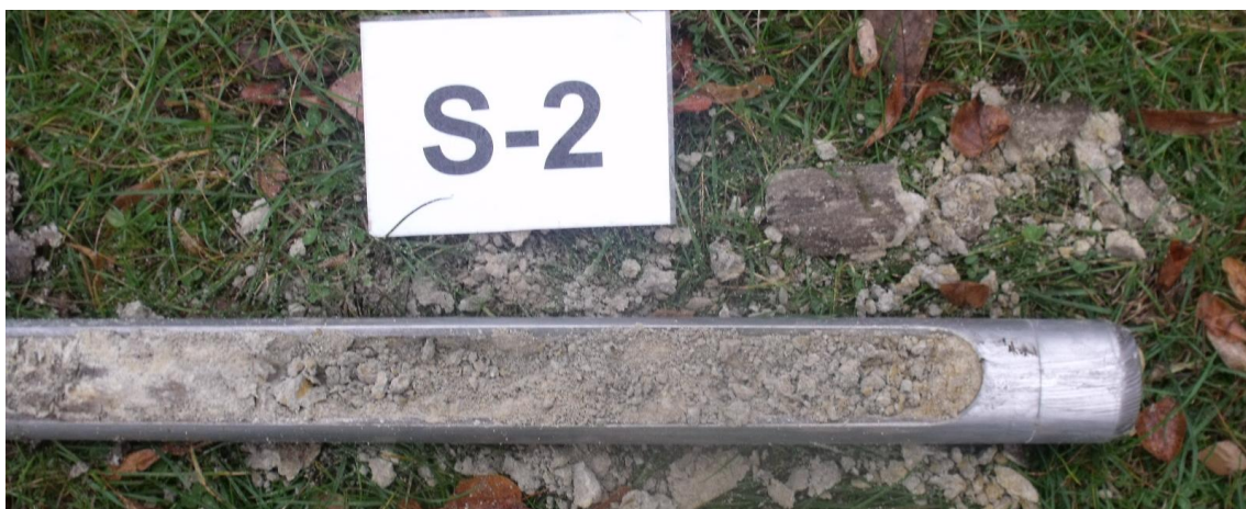
Obr. 16 Zastižené horniny sondou S-2 v hloubce 1,5 – 2,0 m
