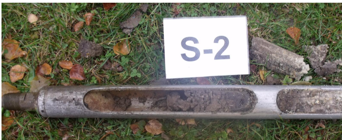
Obr. 15 Zastižené horniny sondou S-2 v hloubce 1,0 – 1,5 m
