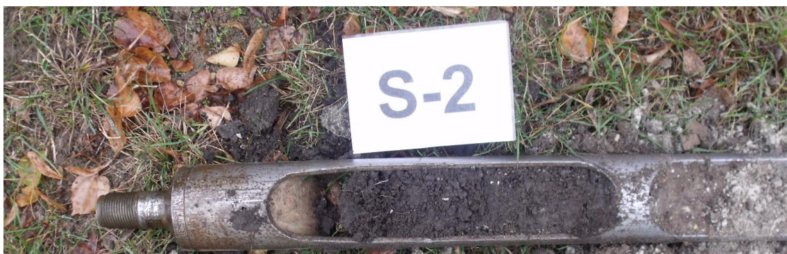
Obr. 12 Zastižené horniny sondou S-2 v hloubce 0,0 – 0,5 m
