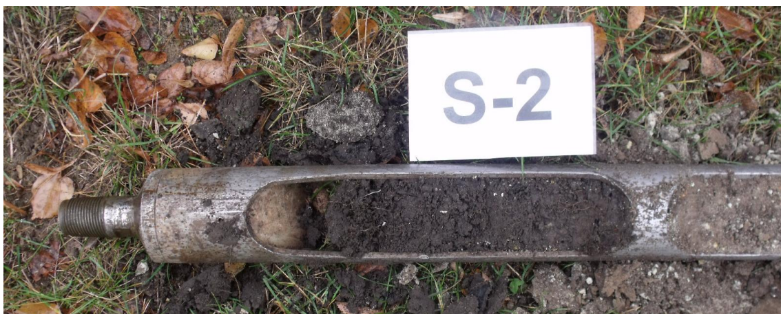
Obr. 9 Zastižené horniny sondou S-2 v hloubce 0,0 – 0,5 m
