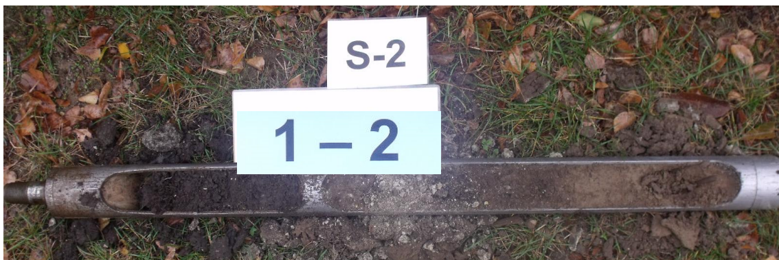
Obr. 11 Zastižené horniny sondou S-2 v hloubce 1,0 – 2,0 m
