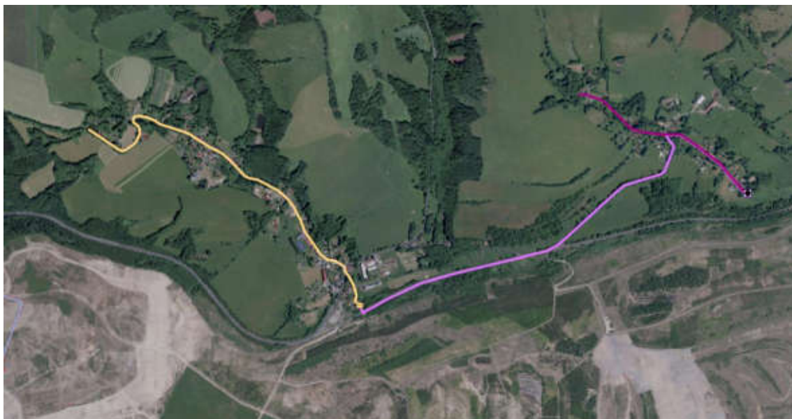
Obrázek 33 - Situace v ortofoto mapě - gravitační kanalizace Horní a Dolní Nivy s novou ČOV, gravitační kanalizace H. Rozmyšl s novou ČSOV a výtlakem do D. Niv
