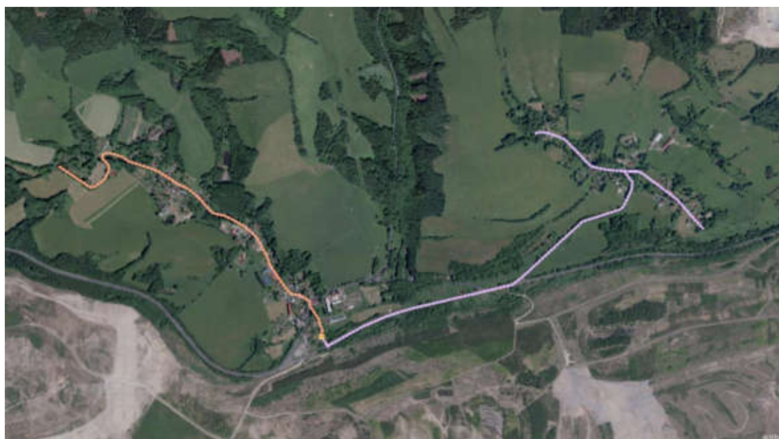
Obrázek 40 - Situace v ortofoto mapě - tlaková kanalizace Horní a Dolní Nivy s novou ČOV, tlaková kanalizace Horní Rozmyšl s čerpáním domácímí ČS až do Dolních Niv
