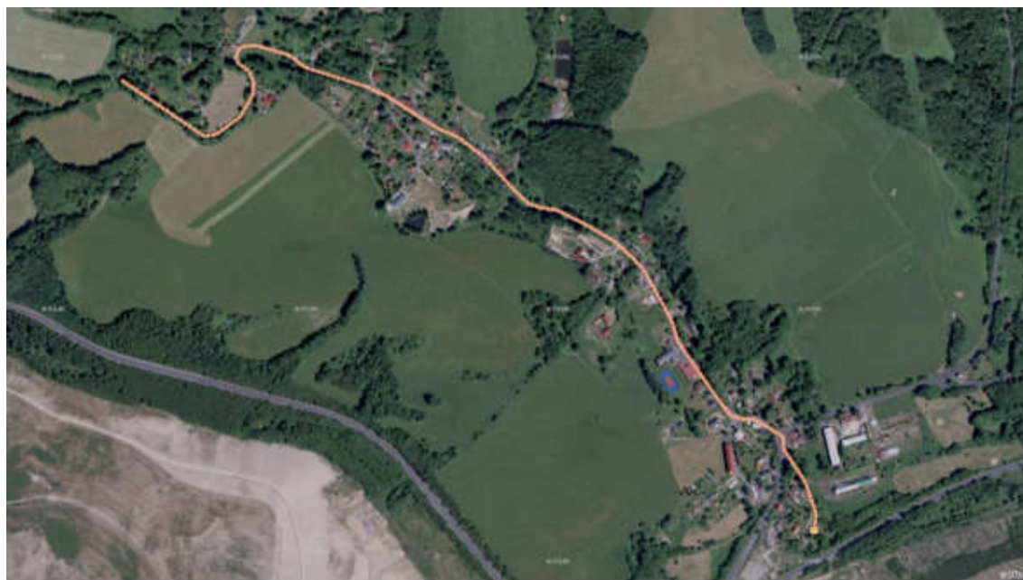
Obrázek 35 - Situace v orotofoto mapě - tlaková kanalizace Horní a Dolní Nivy s novou ČOV
