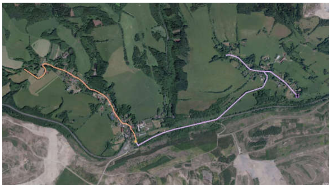
Obrázek 38 - Situace v ortofot mapě - tlaková kanalizace Horní a Dolní Nivy s novou ČOV, tlaková kanalizace Horní Rozmyšl s novou ČSOV a výtlačkem do Dolních Niv
