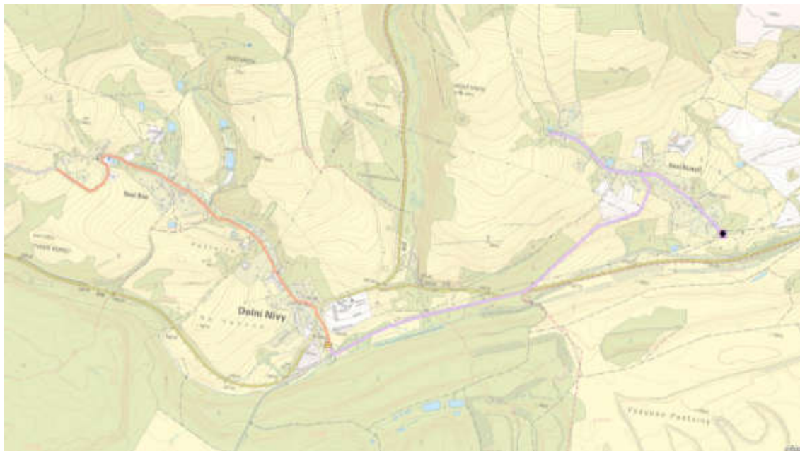
Obrázek 37 - Situace v základní mapě - tlaková kanalizace Horní a Dolní Nivy s novou ČOV, tlaková kanalizace Horní Rozmyšl s novou ČSOV a výtlačkem do Dolních Niv
