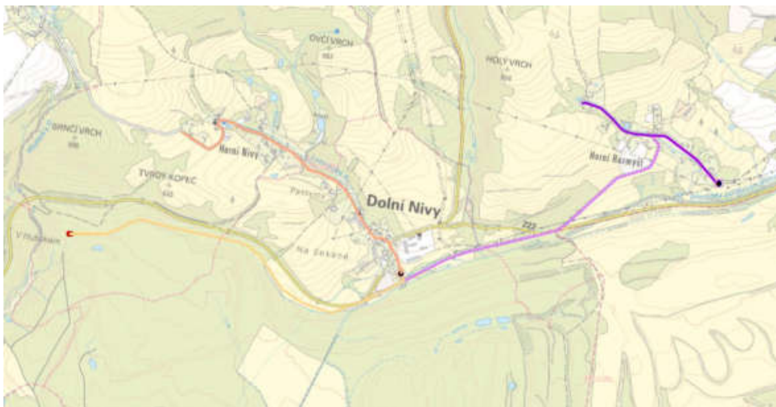
Obrázek 43 - Situace v základní mapě - gravitační kanalizace Nivy s novou ČSOV a výtlakem do ČOV pro průmyslovou zónu, gravitační kanalizace H. Rozmyšl s novou ČSOV a výtlakem do Dolních Niv
