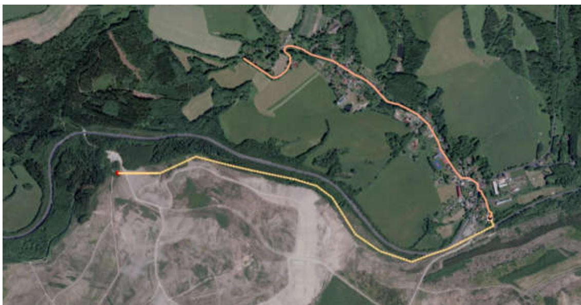
Obrázek 41 - Situace v ortofoto mapě - Gravitační kanalizace Horní a Dolní Nivy s novou ČSOV a výtlačkem do ČOV pro průmyslovou zónu,
