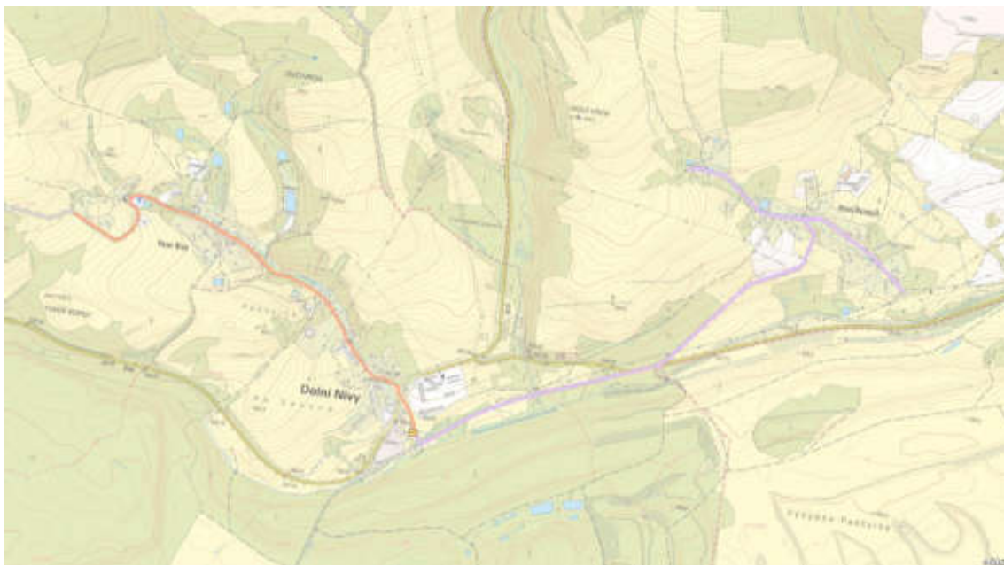
Obrázek 39 - Situace v základní mapě - tlaková kanalizace Horní a Dolní Nivy s novou ČOV, tlaková kanalizace Horní Rozmyšl s čerpáním domácímí ČS až do Dolních Niv
