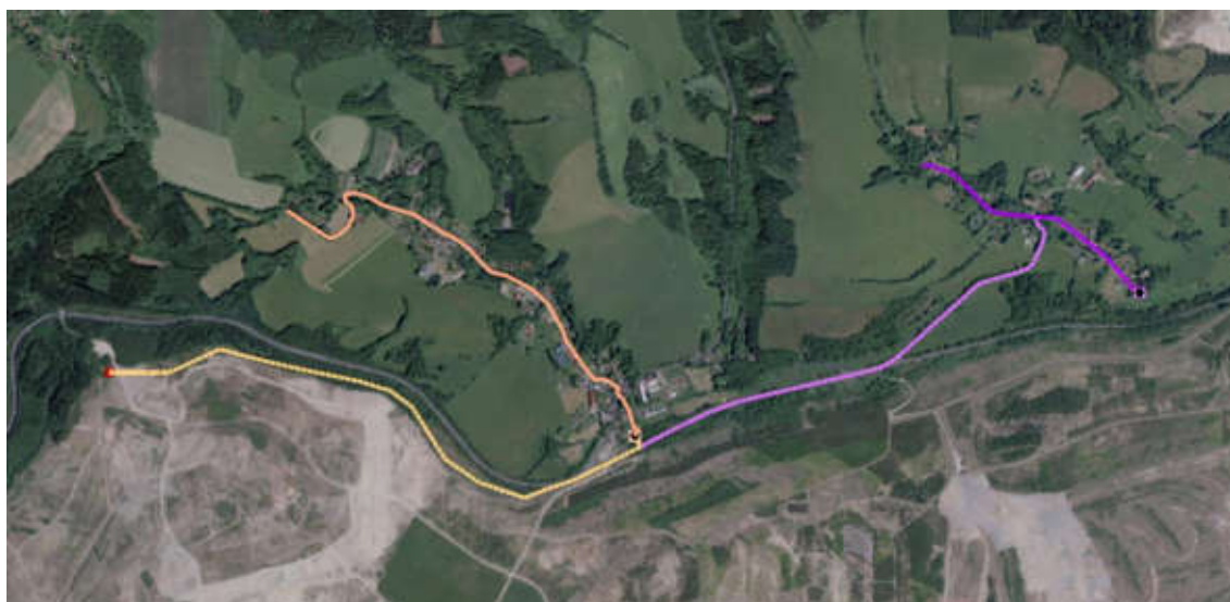
Obrázek 44 - Situace v ortofoto mapě - gravitační kanalizace Nivy s novou ČSOV a výtlakem do ČOV pro průmyslovou zónu, gravitační kanalizace H. Rozmyšl s novou ČSOV a výtlakem do Dolních Niv
