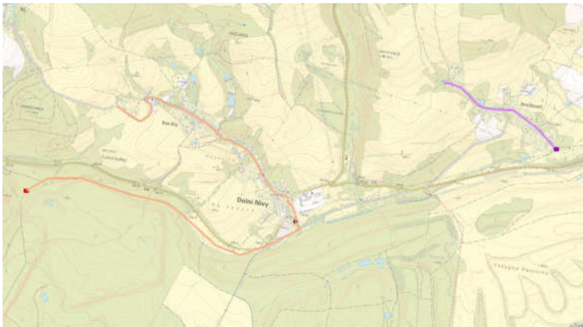
Obrázek 45 - Situace v základní mapě - tlaková kanalizace Horní a Dolní Nivy s novou ČSOV a výtlakem do ČOV pro průmyslovou zónu, tlaková kanalizace Horní Rozmyšl s novou ČOV
