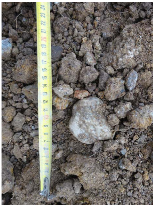
Obr. 8. Detail polohy jílu s příměsí valounů křemene.
