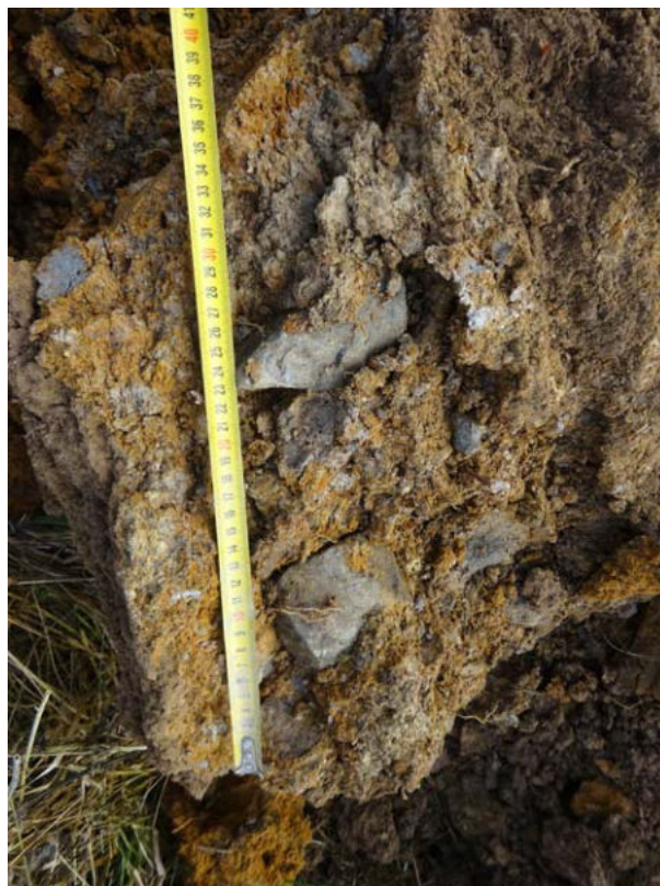
Obr. 6. Detail polohy jílu s příměsí kamenů bazaltu.
