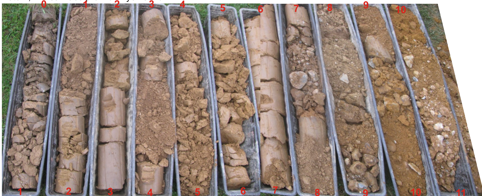
Foto 3 : vyvrtané jádro vrtu J2 v metrži 0 - 11 m
