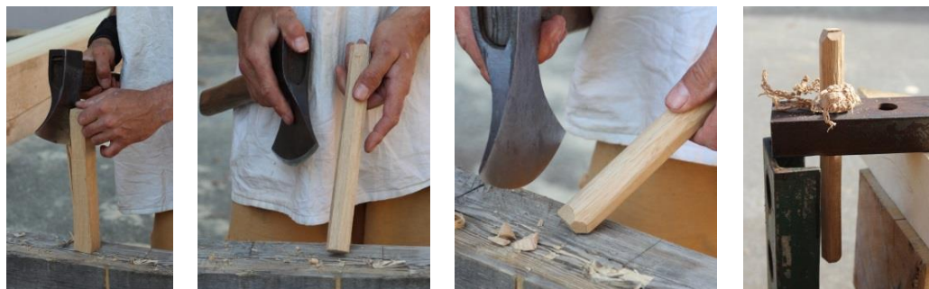
Obr. 15 Postup výroby kolíků
