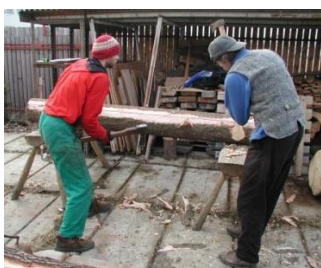
Obr. 41 Vrubování (vlevo, uprostřed) [16], hrubování (vpravo)
