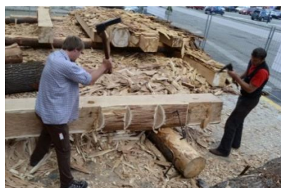
Obr. 41 Vrubování (vlevo, uprostřed) [16], hrubování (vpravo)
