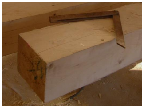
Obr. 40 a) Pokosník, b) značkovací šňůra s hlinkou
