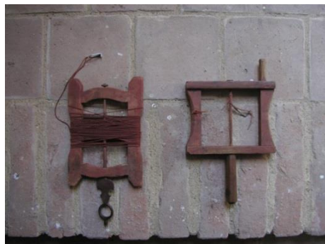
Obr. 40 a) Pokosník, b) značkovací šňůra s hlinkou
