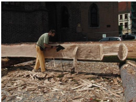
Obr. 42 a) Lícování, b) tlakové dřevo smrku
