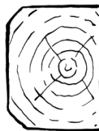
Obr. 12 a) Centrický profil ostře hraněný, b) centrický profil s oblinami, c) excentrický profil s oblinami na jedné straně prku
