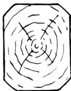
Obr. 12 a) Centrický profil ostře hraněný, b) centrický profil s oblinami, c) excentrický profil s oblinami na jedné straně prku
