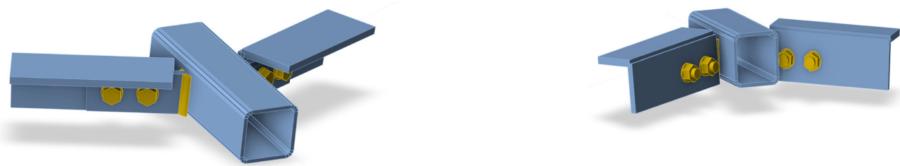
OTVOR PRO UTAŽENÍ ŠROUBŮ VE VZPĚRÁCH
