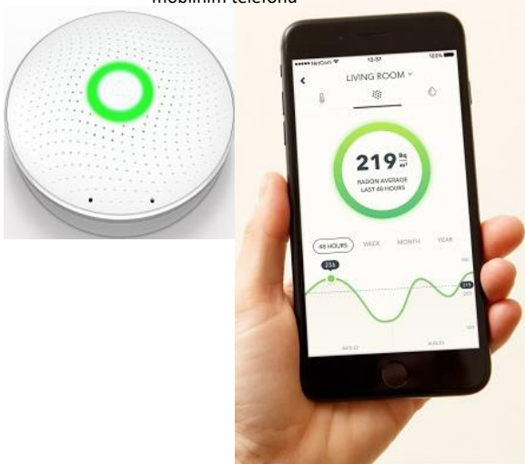
Obr.11 Wave - čidlo a vyhodnocování v mobilním telefonu
